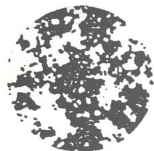
凝集したセメント粒子 （ストロングスーパーなし）
